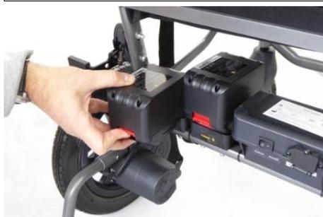
As baterias podem ser removidas pressionando a aba vermelha para cima e puxando para trás.
