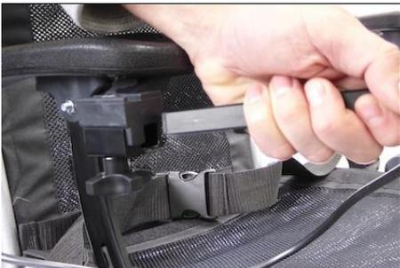
**7** ...insira a haste do controlador no encaixe do apoio de braço sob o apoio de braço...
