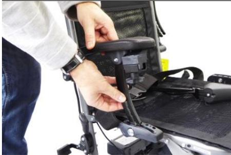
**5** Instale os suportes do apoio de braço nos slots e pressione-os para baixo até travar.
