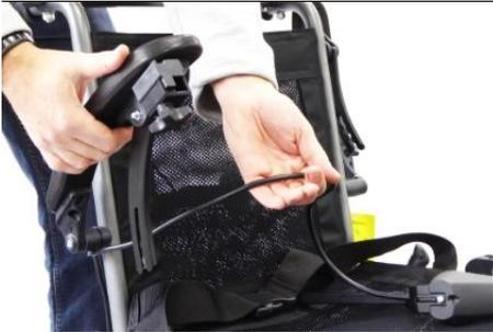
**4** Mantenha o cabo do controlador longe de pontos de aperto, como os suportes do apoio de braço.
